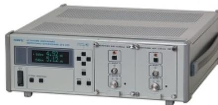
В режиме модуляции модулирующий электрический сигнал может подаваться с внутреннего генератора на частоте 270 Гц и с внешнего генератора Г4-164 в диапазоне от 0,1 до 10 МГц. Наличие интерфейса позволяет использовать прибор в автоматизированных системах с управлением от ПЭВМ.
